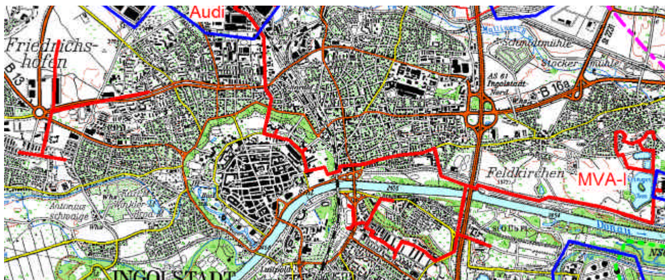
Bild 4.5-1: Übersicht über die Haupt-Fernwärme-Leitungstrassen der Stadtwerke Ingolstadt
