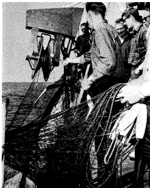
Trækmaskine til laksegarn - også et eksempel på fiskeriets effektivisering. Udviklet af Povl Ebsen, der var auktionsmester i Nexø 1967-72. Foto fra demonstration af trækmaskinen ombord på SE 54 "Palle".
