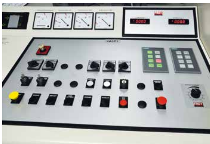
Steuerschränk mit Hauptantriebs-, Kopierwerks- und Bremsensteuerung - im rechten Bild das modifizierte Steuerpult.
