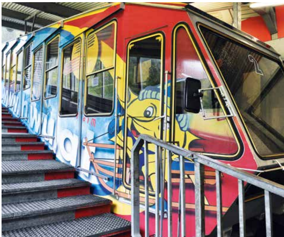
Die Wurzeralm-Standseilbahn in Spital am Phyrn fährt mit einer max. Fahrgeschwindigkeit von 14 m/s und gilt als eine der schnellsten Standseilbahnen Europas.
