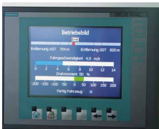
Durch die WLAN-Anbindung können die Betriebsdaten am Touch-Panel im Fahrzeug abgelesen werden. Dem Fahrzeugbegleiter stehen alle notwendigen Informationen zur Verfügung.
