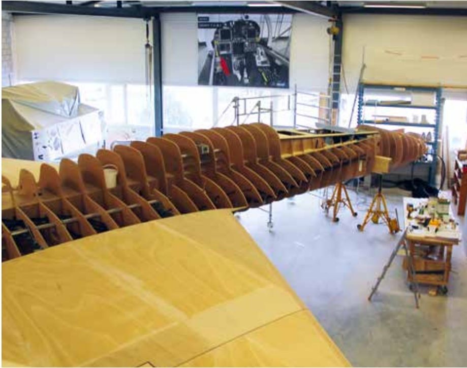
Das wird ein „Kampfflieger zum Üben“. Die Spezialisten von WOLFKABINE fertigen bereits den zweiten F/A 18 Mock Up für die Schweizer Armee. Überarbeitet wird er noch mehr wichtige Simulationsmöglichkeiten für die Soldaten bieten.
