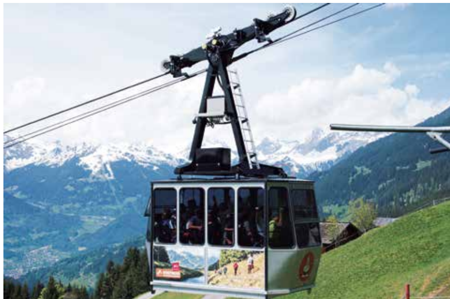
Die seilbahntechnische Besonderheit einer einspurigen Pendelbahn - die damit genau dem konkreten Transport-Bedarf entspricht ... und zudem besonders kostengünstig errichtet wurde.
