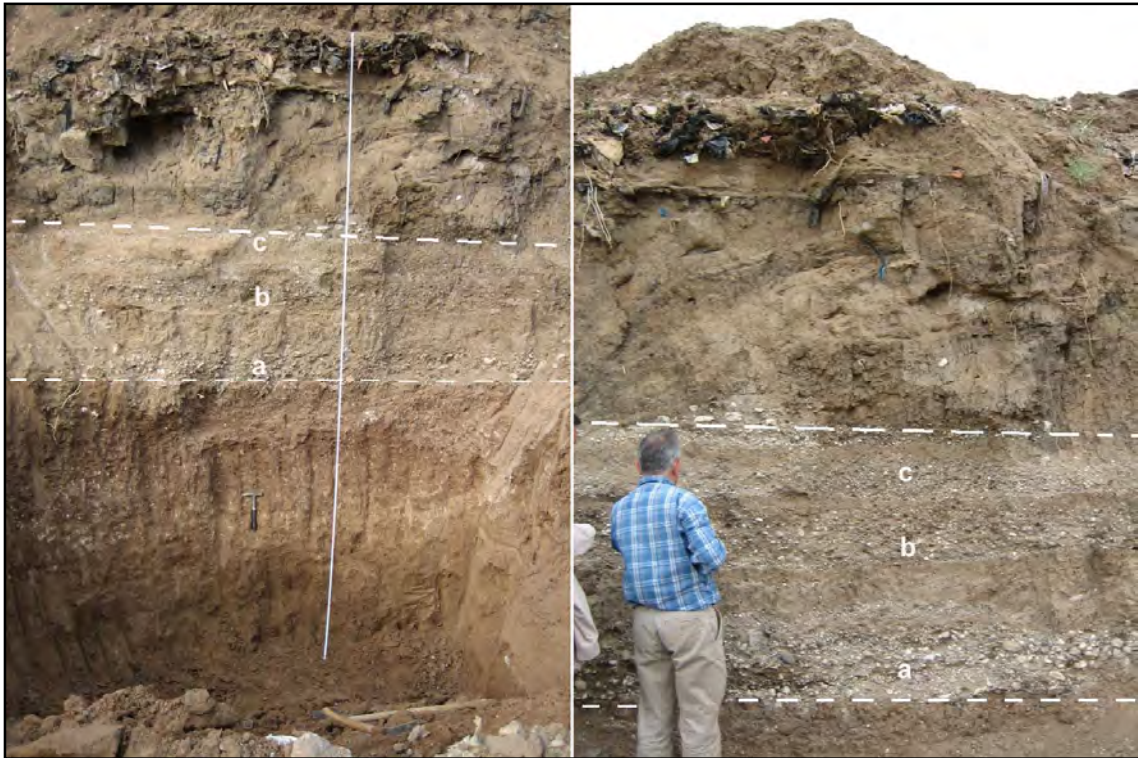
Foto 1: 2 nolu gözlem kuyusuna ait stratigrafik kesit. Bu kesitte geçmişte yaşanan 3 büyük taşkına ait seviyeler (a, b, c) görülmektedir.
