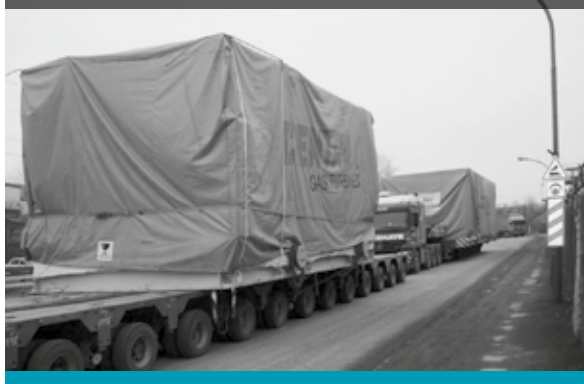
4. KÉP: A GÁZTURBINA ÉS GENERÁTOR PACKAGE SZÁLLÍTÁSA AZ ERŐMŰBE
