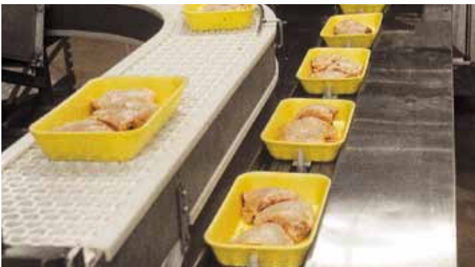
Produkteinlauf in die Schlauchbeutelmaschine.
