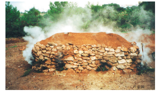
Sitja coguent. Observi's els "forats" superiors i les "boques" per on surt el fum.
