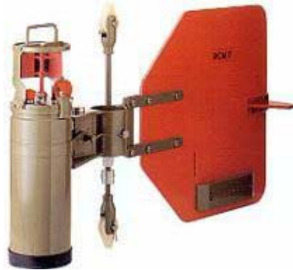
Figure 14 - The Aanderaa doppler current meter
