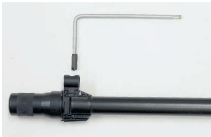
Приведение винтовки с механическим прицелом к нормальному бою проводится коленчатым ключом с установленной на нём насадкой из комплекта инструмента
