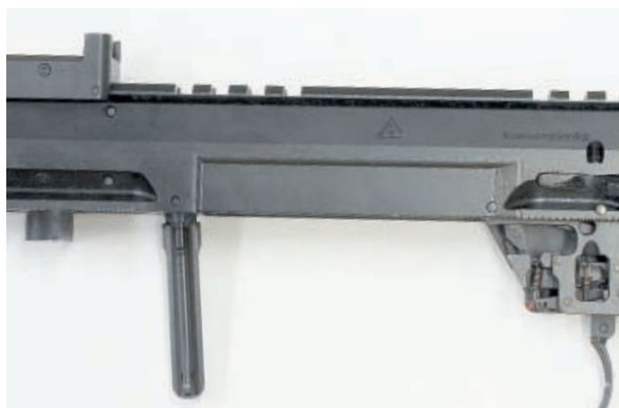
Хорошо видна стойка, на которую одевается и фиксируется магазин
