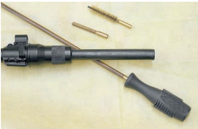
Чистка ствола с дульной части производится через пластмассовый насадок, фиксируемый защитным колпачком
