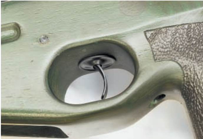
В условиях запыления на спусковой крючок одевается резиновое кольцо выпуклой стороной вниз. В комплекте ЗИП оно одно!
