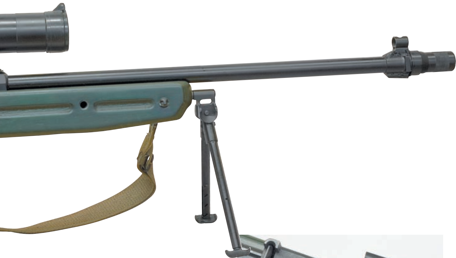
Шпенёк для крепления проушины противомиражной ленты находится на переднем конце планки Пикатини
