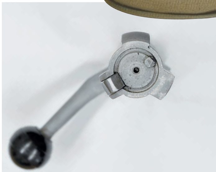
SV-98 оснащена продольно скользящим «болтовым» затвором (с поворотом при заперении). Запирание канала ствола производится тремя симметрично расположенными боевыми выступами затвора
