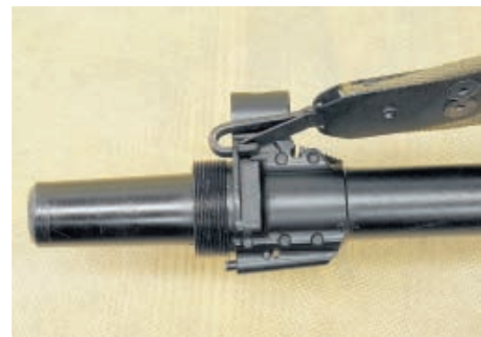
Переноска винтовки в положении «на грудь» очень удобна и позволяет вести стрельбу навскидку. Карабинчик ремня при этом перемещается с антабки ложи на антабку основания мушки, а дополнительный ремешок за рукоятку для переноски
