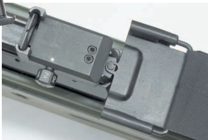
Шпенёк для крепления проушины противомиражной ленты находится на переднем конце планки Пикатини
