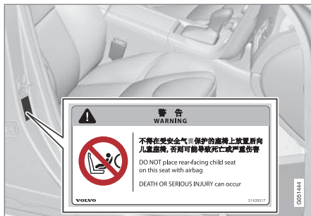
标贴位于乘客侧车门柱上。打开乘客车门，可以看到此标签。
