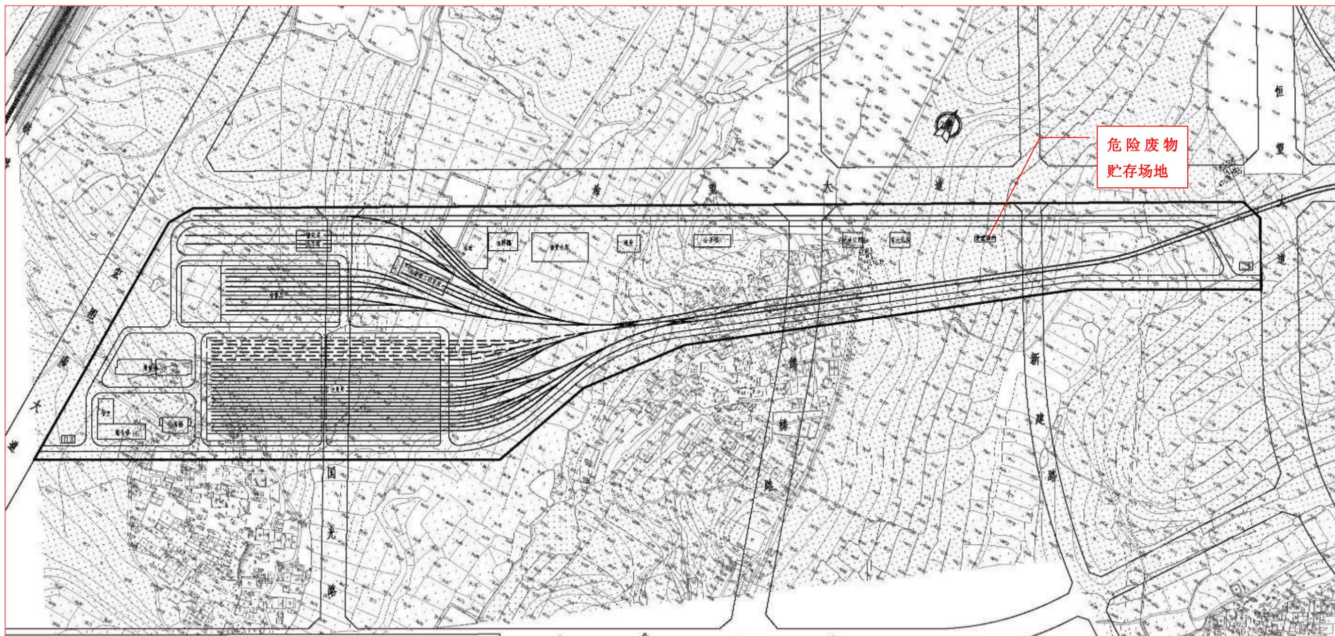
图 2.1-2 望城车辆段平面布置图
