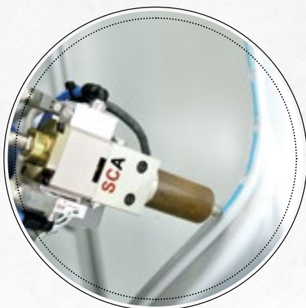
Bei der Steppnaht-Applikation kommt es darauf an, dass die Steuerung millisekundengenau arbeitet.
