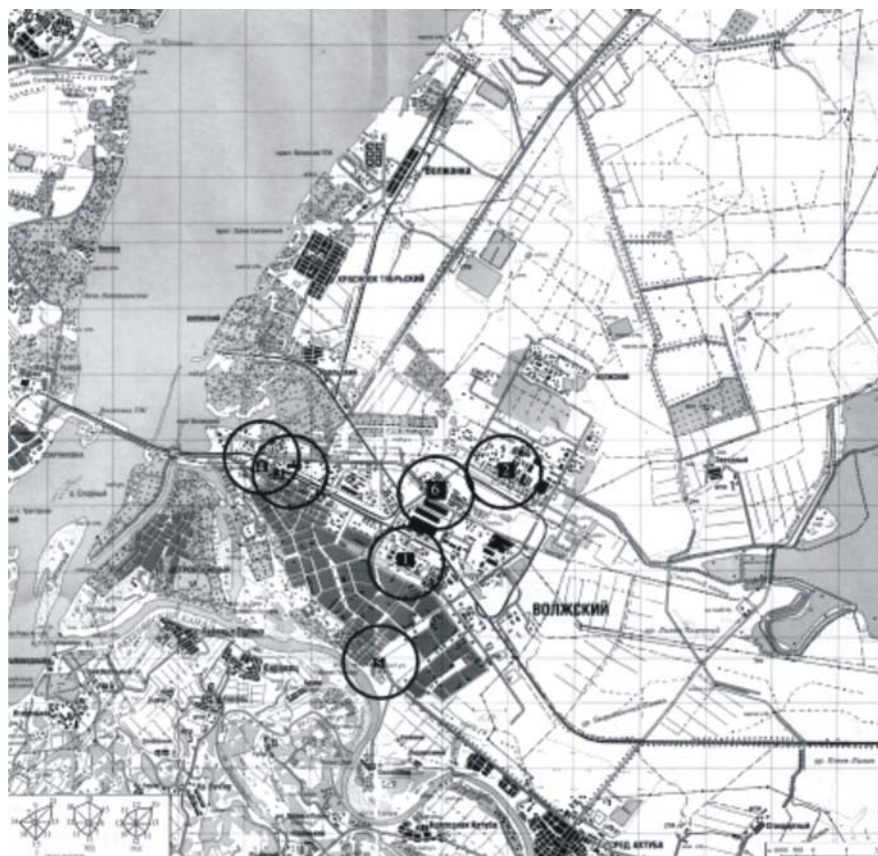
Рис. 3. Схема формирования зон равных концентраций вредных выбросов от машиностроительной отрасли в атмосферу с учетом равновероятного направления ветра (по А.А. Кошелеву)
