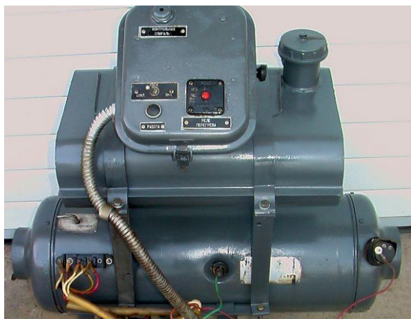
Рисунок 4.2 – Опалювально-вентиляційна установка самохідних гармат
