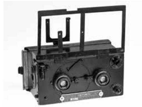
Stereokamera „Le Stéréo-Panoramique Leroy“ für Glasplatten im Format 6 x13 cm, um 1914, Sammlung Wirth Hildesheim. Mit einer ähnlichen Kamera haben auch Otto Mötje und Karl Bußhoff ihre Aufnahmen gemacht. Foto: Christoph Steinweg, © LWL-Medienzentrum für Westfalen
