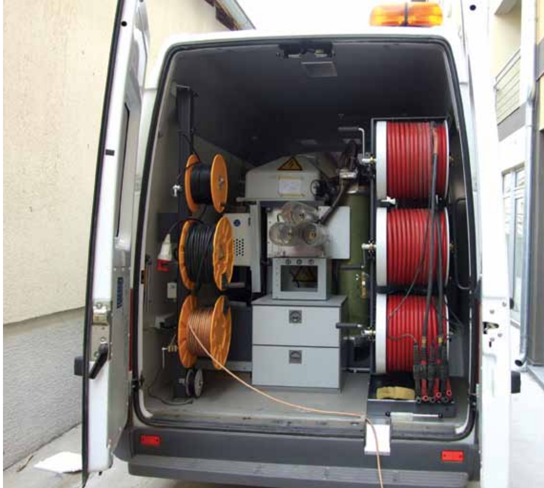
• Модерна мерно – испитна кола „Електрошумадије“
