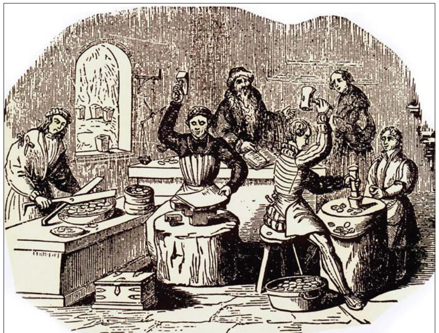
Рисунок 2. На этой старинной гравюре представлен процесс средневековой чеканки монет. В центре рабочий “правит” металлические пластины до нужной толщины. Слева от него заготовитель нарезает кружки требуемого диаметра. Справа мастер с помощью молота и верхнего чекана “бьет” монеты из заготовок, которые выкладывает на нижний чекан его подмастерье. За ними владелец монетного двора и заказчик-эмитент подсчитывают готовую продукцию.
