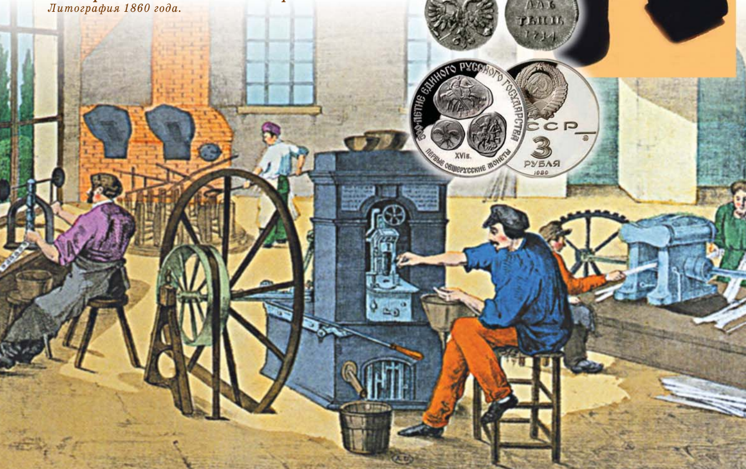
Рисунок 5. Чеканы российского “машинного” производства монет из круглых заготовок конца XVII века, пришедшие на смену проволочной технологии. Снизу алтын 1714 года и современная памятная монета Банка России с изображениями старинных монет, передающих технологическую трансформацию чеканочного производства своей страны.
