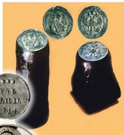
Рисунок 5. Чеканы российского “машинного” производства монет из круглых заготовок конца XVII века, пришедшие на смену проволочной технологии. Снизу алтын 1714 года и современная памятная монета Банка России с изображениями старинных монет, передающих технологическую трансформацию чеканочного производства своей страны.
