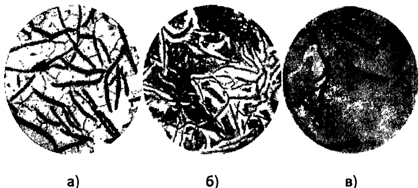
Рис.9. Микроструктура серых чугунов: а) ферритного ( \Phi + \Gamma ); б) ферритно-перлитного ( \Phi + \Gamma ); в) перлитного ( \Pi + \Gamma )
