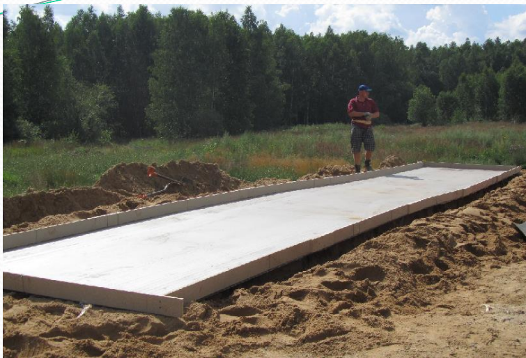
Пакет с зарядом ВВ размерами 31(26+5) \times 2100 \times 13100 мм
