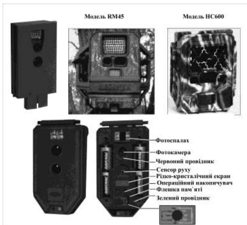
Рис. 1.1. Сучасні фотопастки та їх конструктивні особливості.
