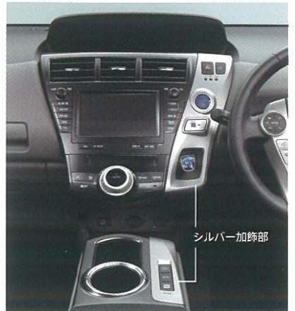
運転操作に必要なスイッチ類をドライバー側に集約。シルバー加飾による区分も図り、直感的に操作できる使いやすいレイアウトを実現しています。
