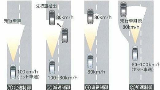
①定速制御 希望の車速(約50km/h~100km/h)で走行中に、レーダークルーズコントロールスイッチでセットすることにより定速走行を開始。
