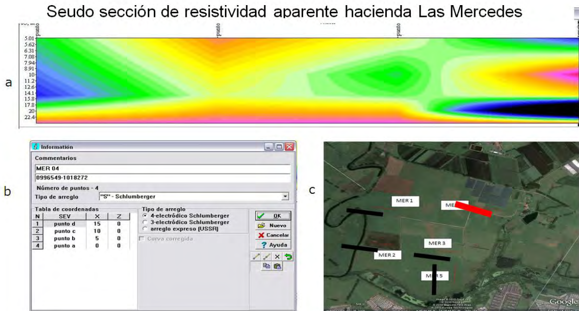
Imagen 65. a) Distribución de resistividad observada o seudo-sección de resistividad hacienda Las Mercedes; b) salida del programa IPI2WIN y c) localización de los perfiles ejecutados, en rojo el interpretado en a)
