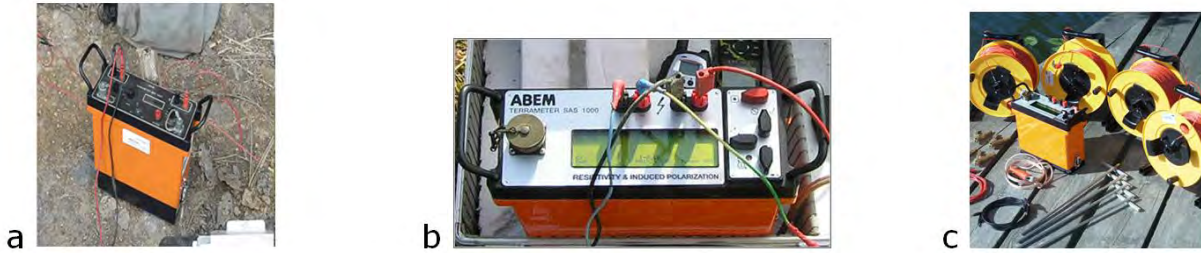
Imagen 58. Terrameter ABEM SAS 1000. a) Sistema de medida; b) Tablero de operación; c) Periféricos: electrodos y cables para tendido de fuente o inyección de corriente y de receptores.
