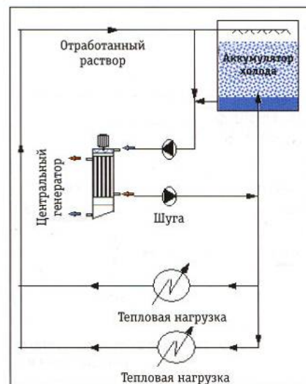
Рис 9. Централизованная система аккумуляции холода при помощи шуги
