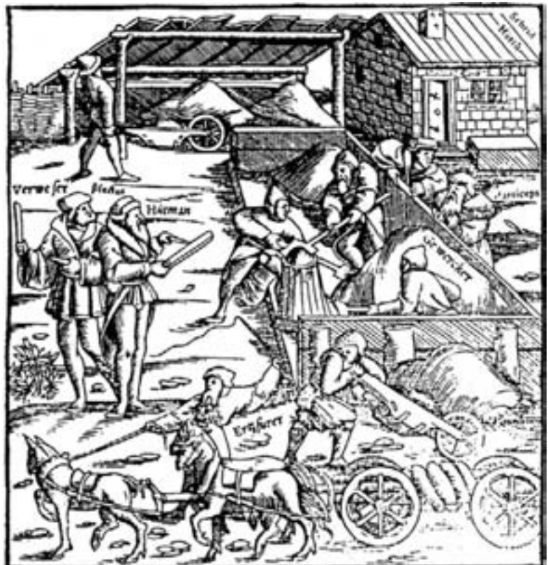
Eisenherstellung in der frühen Neuzeit: Am Stapelplatz wird frisch angeliefertes Erz mit dem Kübel abgemessen. Holzschnitt aus Sebastian Münsters «Kosmographie», 1550.
