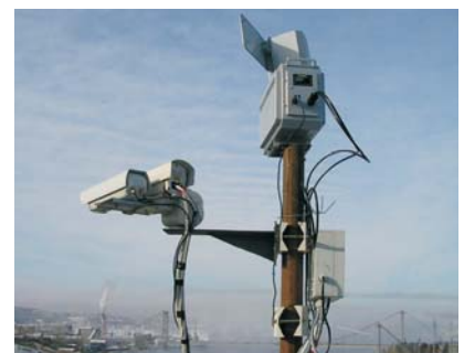
СВЧ-приемопередатчики диапазона 17ГГц для радаров охранный системы
