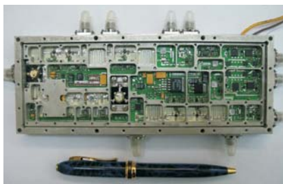
Приемопередающий модуль для связной АФАР на диапазон 5ГГц
