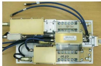
СВЧ-приемопередатчики диапазона 17ГГц для радаров охранный системы
