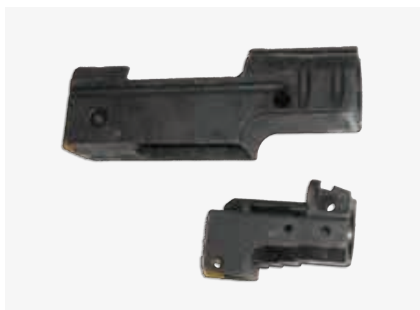
„Sturmgewehr 44“ (viršuje) ir AK 47 uoksų palyginimas. < http://www.forgottenweapons.com/ak-and-stg-kissing-cousins/ >, [žiūrėta: 2014 05 08].
