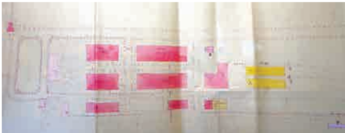
Ginklavimo valdybos civ. tarnautojo architekto B. Elsbergo sudaryto Linkaičių artilerijos dirbtuvių situacijos plano dalis. 1937 m. birželio 7 d. plane pavaizduotas pastatų išsidėstymas teritorijoje. Raudona spalva pažymėti pastatyti arba dar statomi mūriniai pastatai. Rožine spalva pažymėti planuojami statyti mūriniai pastatai. Geltona spalva pažymėti planuojami statyti mediniai pastatai.
