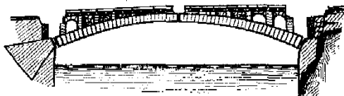
Brücke vor dem Ausgießen der Bleifugen, nur durch die Bleigelenke getragen.
