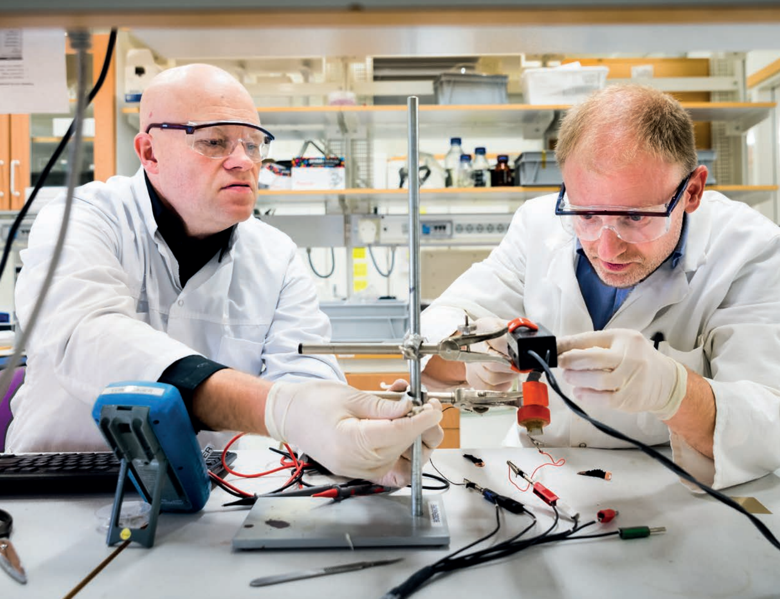
Nils-Krister Persson vid Högskolan i Borås (vänster) och Edwin Jager vid Linköpings universitet (höger) monterar en "textil muskel" i en uppställning av mätinstrument som mäter kraft.
