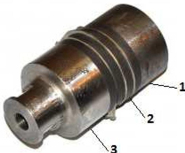
Рис. 1.32. Многослойный пьезокерамический преобразователь частотой 22 кГц на пьезоэлементах диаметром 50 мм: 1 – амортизирующая накладка; 2 – пьезокерамические кольца; 3 – излучающая накладка
