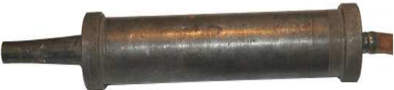
Рис.1.22. Магнитострикционный преобразователь на частоту 22 кГц и мощность 360 Вт
