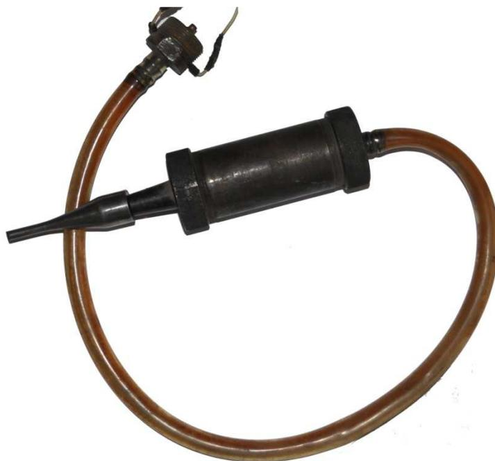
Рис.1.23. Магнестрикционный преобразователь с точечным ультразвуковым инструментом экспоненциальной формы, рассчитанный на частоту 40кГц
