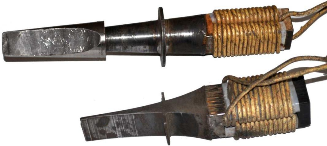
Рис.1.20. Ультразвуковые излучатели с обмоткой возбуждения
