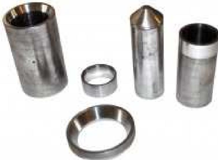
Рис. 3.4. Пресс-форма для изготовления подшипников скольжения
