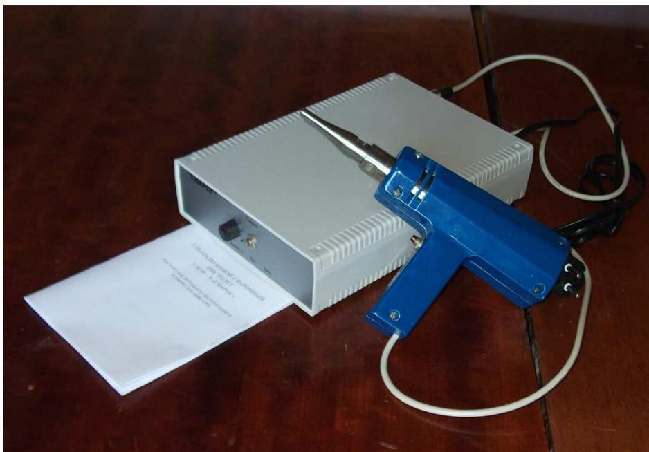
Рис. 2.34. Внешний вид аппарата УЗСП-9 «СВАРОГ»
