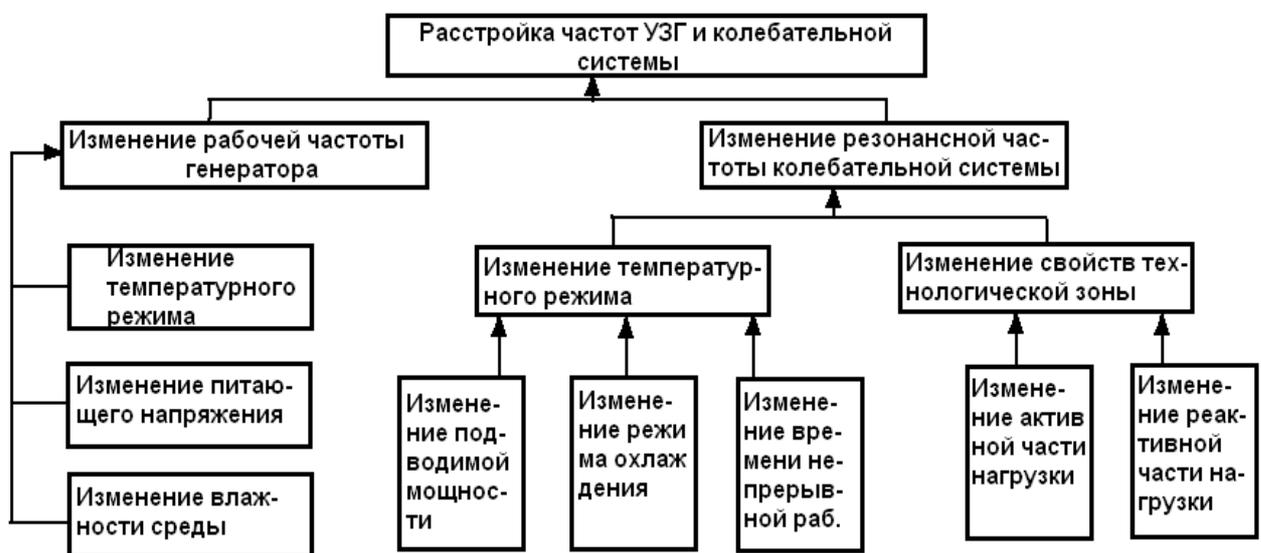
Рис.2.14. Факторы, влияющие на стабильность амплитуды механических колебаний излучающей поверхности колебательной системы посредством частотного рассогласования
