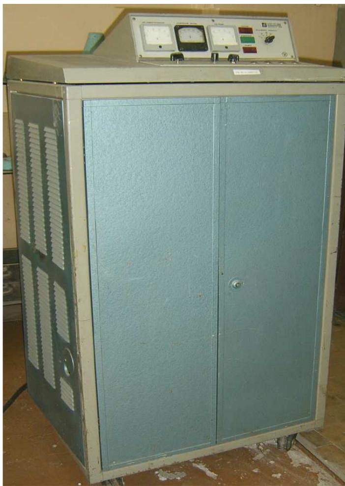
Рис. 2.4. Внешний вид ультразвукового генератора УЗГ2-4М
