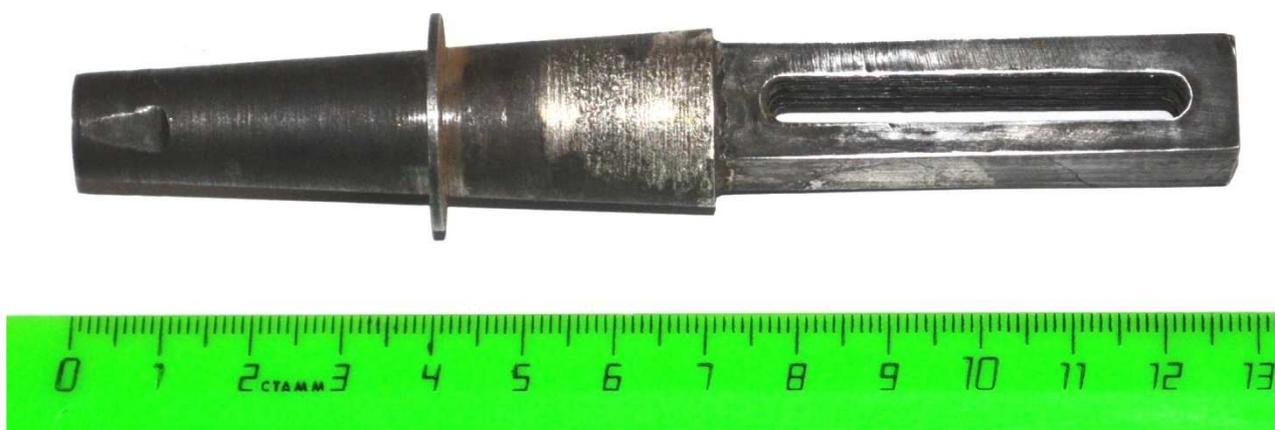
Рис.1.19. Трансформатор колебаний и преобразователь, спаянные между собой
