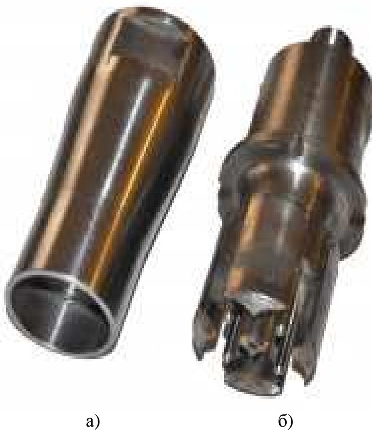
Рис. 3.10. Общий вид ультразвукового инструмента для ультразвукового прессования подшипников (а) и уплотнительных втулок (б) из ПКМ
