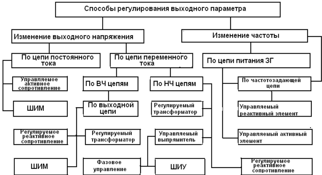
Рис. 2.19. Основные методы регулирования выходного параметра УЗ генератора
