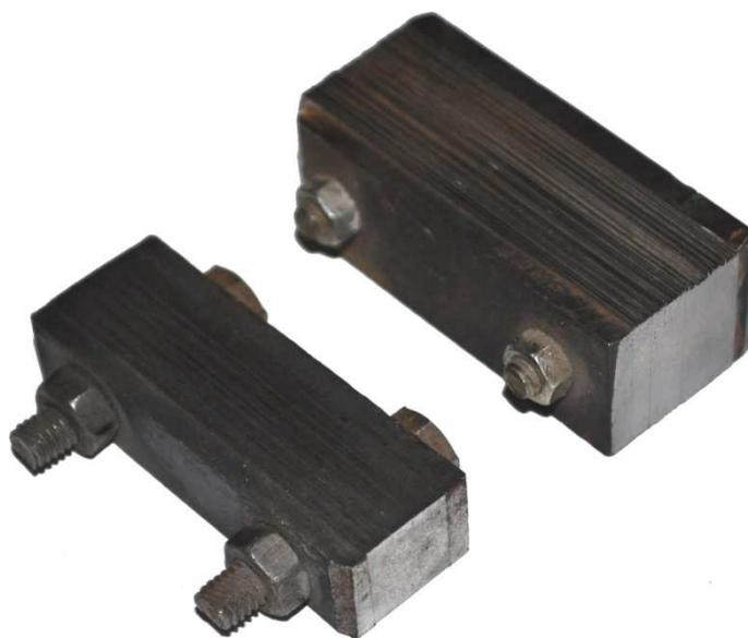
Рис.1.17. Внешний вид пакетов после отжига и шлифования торцов
