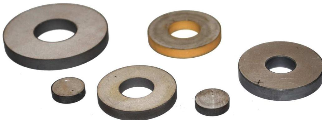
Рис. 1.24. Пьезокерамика типа ЦТС
