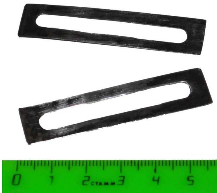
Рис.1.16. Пластины магнестрикционного преобразователя из сплава К49Ф2, рассчитанные на частоту 40кГц
