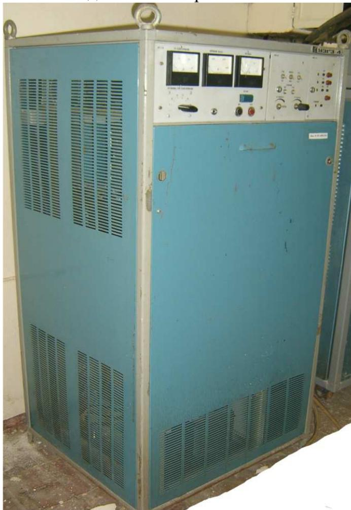
Рис. 2.6. Ультразвуковой генератор УЗГ3-4
