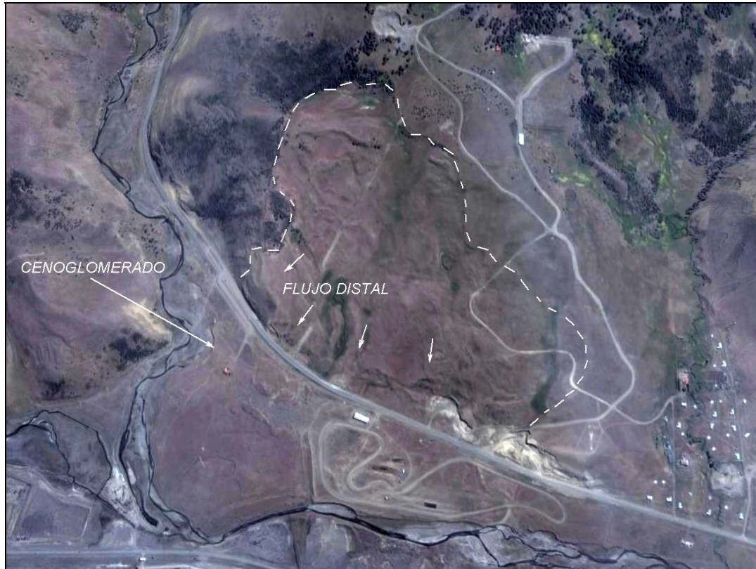
Figura 71. Caída de pendiente que culmina en un flujo, 2 km aguas arriba de la Alternativa 1. El cenoglomerado de la Figura 19, cuya localización se señala mediante la flecha, se vincula con este movimiento de remoción en masa.
