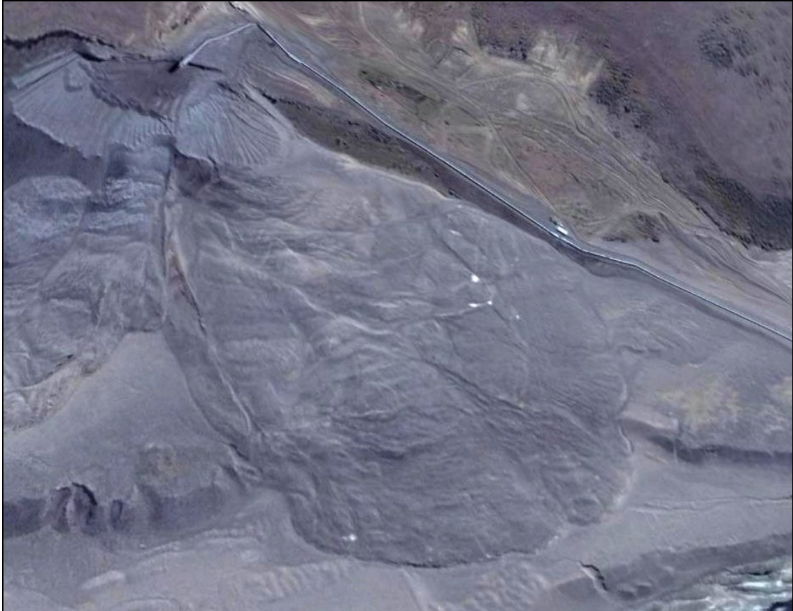
Figura 72. Remoción en masa afectando pilas de estéril.
