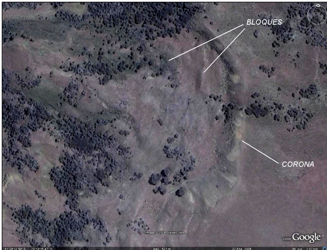
Figura 66. Sección del valle superior del río Turbio afectada por deslizamientos rotacionales. El área movilizada está limitada por una clara cicatriz o corona superior semicircular que encierra el sector en el cual se localizan varios bloques asentados. Hacia la sección inferior se observa una zona afectada por flujos parcialmente encauzados.
