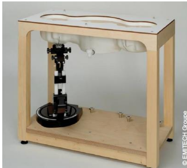
Figure 1 : exemple de téléphone placé contre le mannequin représentant la tête remplie de liquide
