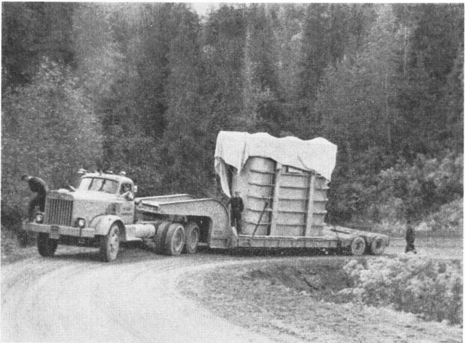
Røssåga kraftanlegg. Transport av transformator.
