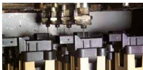
La spira secondaria è inglobata nella resina fusa tramite fusione a vuoto.
