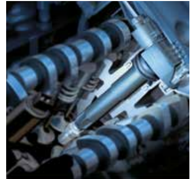
Le bobine d'accensione montate nel cappuccio candela sono installate in profondità all'interno del vano motore e devono sopportare carichi termici estremi.
