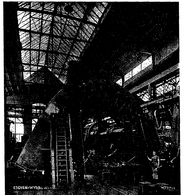
FIG. 8. — Bâche spirale de la turbine sur le tour.
