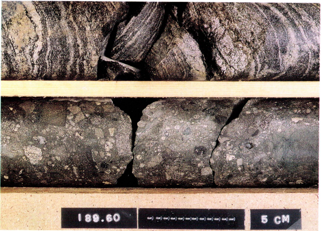
Fig.10. Dike breccia and mica gneiss in DH 385, depth 189.60 m. (Photo by J. Väättäinen).
