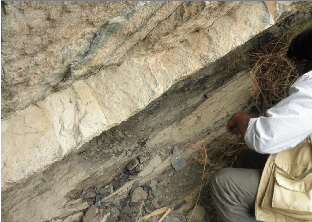
Figura 38. Lodolitas grises con intercalaciones de capas medias de areniscas de grano fino del tope de la Formación Fómeque. Vereda Mercadillo Segundo. (Estación LMP-47, cuadrícula E-2).
