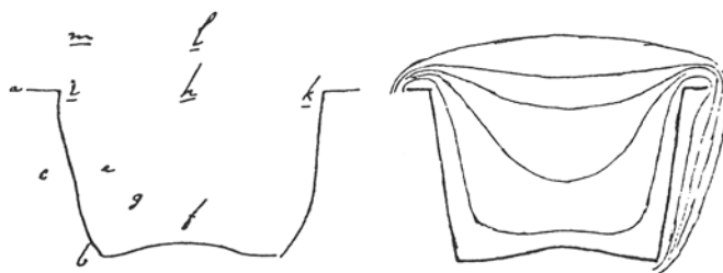
図 29：銅製の容器の周囲における電気的状態の観測点（左）と、観測された力が等しい点を結んだ線（右）（8 December 1835, Diary , 2:414.）
