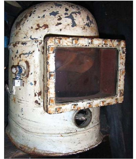
Abb. 5 (Foto: Axel Huber, 2008): Tauchhelm, aus einem Stahlhelm der Deutschen Wehrmacht gefertigt.
