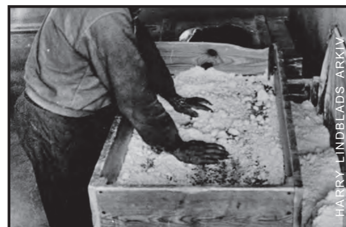
Rivning av nitrocellulosa.
