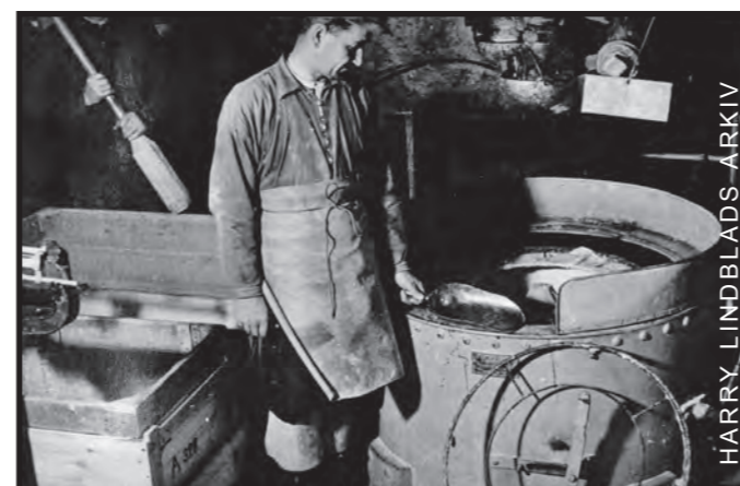
Centrifug som användes för att ta bort vattnet ur nitrocellulosan.
