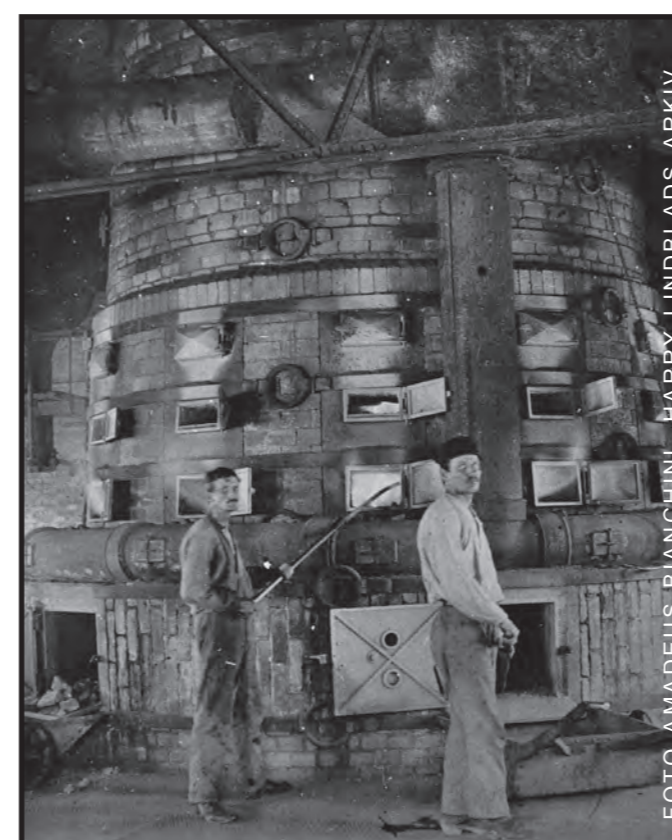
Rostugnen, 1919. Här rostades malmen för att bli porös och gå lätt att dela i mindre bitar.
