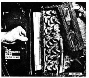
Fig. 34 Replacing Air Filter
