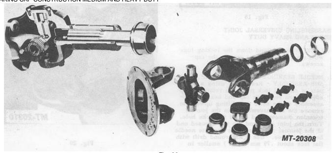
BEARING CAP CONSTRUCTION MEDIUM AND HEAVY DUTY
