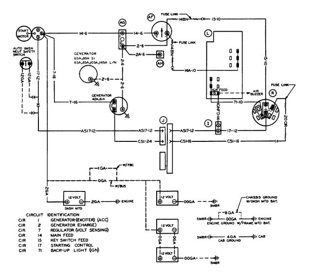
V-392, MV8 &V-345 STARTING, CHARGING&MAJOR FEED & GROUND WIRING FBC/BUS MT-21961
