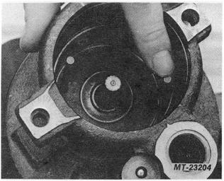
Fig. 25. Install Dowel Pins
