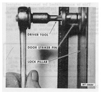
Fig. 26. Removing or Installing Door Striker Pin
