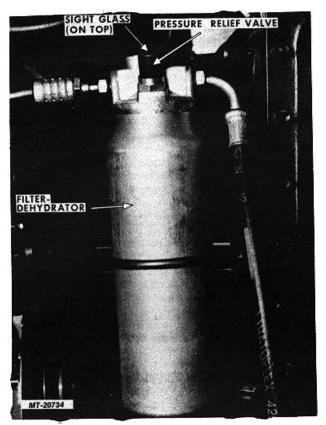
Fig. 9 Filter Dehydrator
