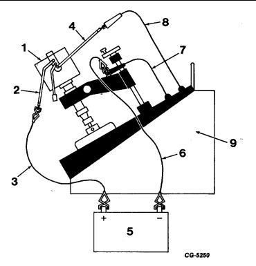
Fig. 9 Distributor-To-Test Stand Wiring
