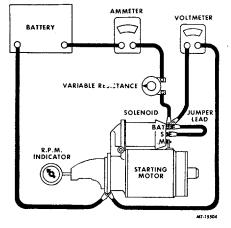
Fig. 6 No Load Test Hookup
