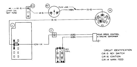
ROAD SPEED CONTROL & ENGINE GOVERNOR W/v-345,v-392 & MV8 ENGINES W/FBC/BUS
