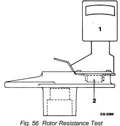
1. Ohms X1000 Meter 2. Resistor
