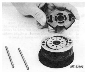
Fig. 14. Remove Thrust Plate
