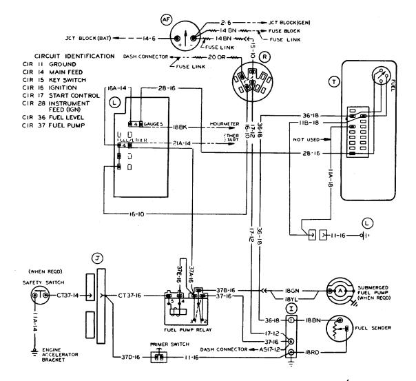
FUEL SENDER & SUBMERGED FUEL PUMP WIRING FBC/BUS MT-23764
