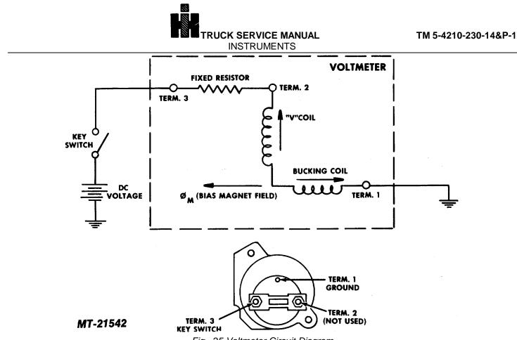
Fig. 25 Voltmeter Circuit Diagram
