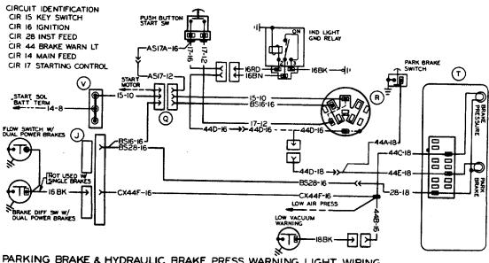
PARKING BRAKE & HYDRAULIC BRAKE PRESS WARNING LIGHT WIRING W SINGLE OR DUAL POWER BRAKES 1600 THRU 1900 LH DR
