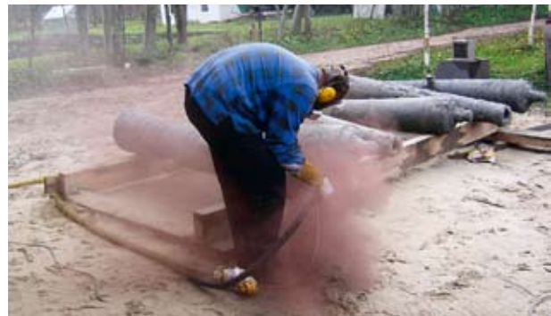
(1) Kuressaare „kraavisuurtükid” lähtepositsioonil konvendihoonel ees 2011. a sügisel. Foto Kristjan Sisa (2) Tulemõll tund pärast tuliüriäda süütamist. Fotod Jüri Peets (3) Töö liivapritsi on väga roostekarva
