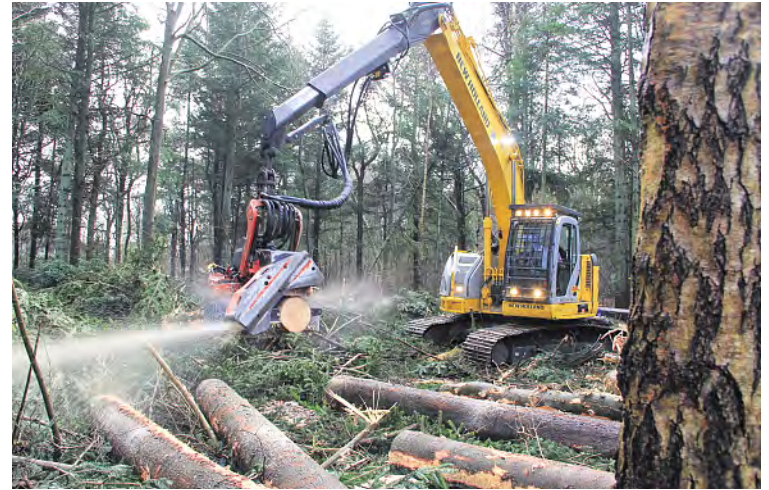
Starker Harvester mit Kettenlaufwerk, der auch mit den starkastigen Kronen der Schwarzkiefer keine Probleme hat.
