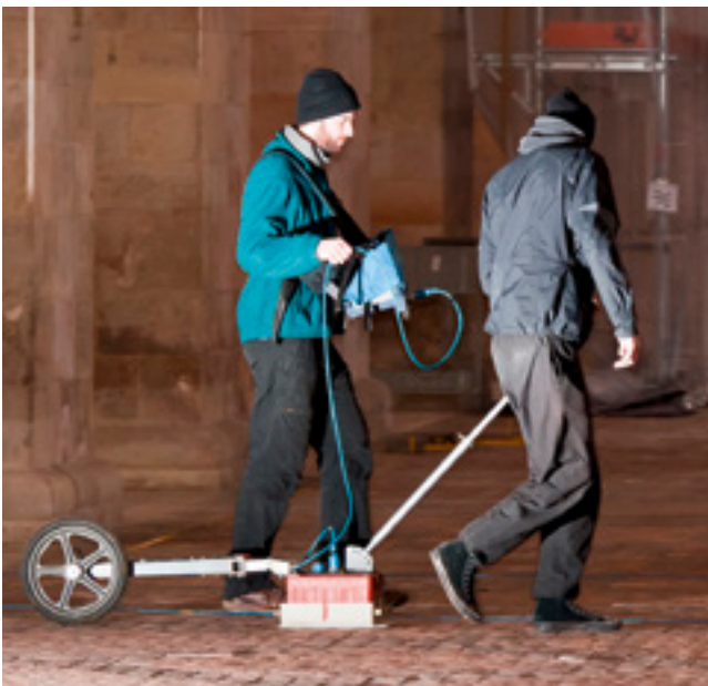
Bodenradarsystem SIR-3000 (GSSI, USA) mit einer 400-MHz-Antenne im Einsatz (Foto: PZP)
