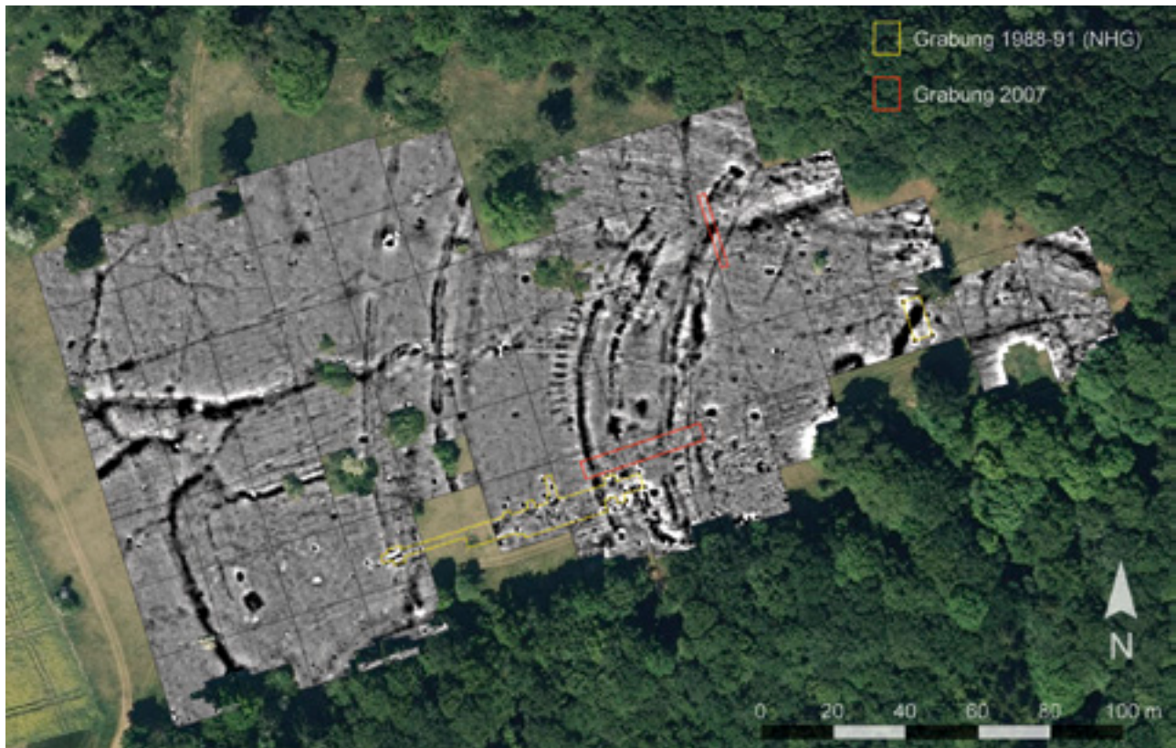
Landersdorf. Orthophoto des Hinteren Bergs mit Magnetogramm. Dual-Fluxgate-Gradiometer Bartington Grad 601-2, Dynamik \pm 12 nT in 256 Graustufen, Messpunktdichte 12,5 \times 50 cm (interpoliert auf 12,5 \times 25 cm), 20-m-Gitter (Luftbild: © Bayerische Vermessungsverwaltung 2014; Geophysik: Lehrstuhl für Vor- und Frühgeschichtliche Archäologie Würzburg)
