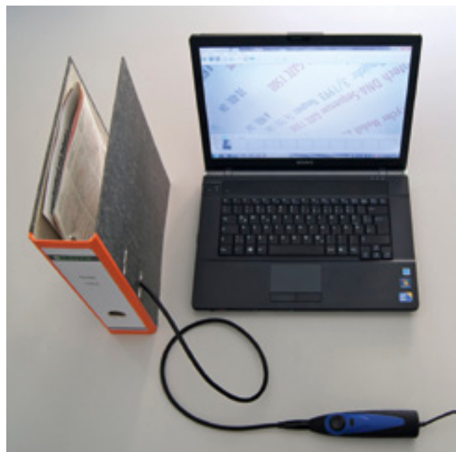
Abb. 6. Preisgünstiges Computer-Endoskop (USB-Endoskop) eines Internet-Discounters. Zur Veranschaulichung der Leistungsfähigkeit solcher Geräte wurde der flexible Bildleiter in den seitlichen Schlitz eines Aktenordners eingeführt. Der Text auf dem Schriftstück im Aktenordner ist per Computer problemlos lesbar. Die regelbare Beleuchtung besorgen in diesem Fall winzige Leuchtdioden (statt der vormals üblichen Faseroptik). Die Ergebnisse der – hier natürlich sinnfreien – Aktion können via Standbild oder Video im Computer gespeichert werden. Achtung: meist keine Fokussiermöglichkeit, deshalb gut im extremen Nachbereich, jedoch mangelnde Schärfe bei größeren Entfernungen. Kopfdurchmesser 7 mm, Arbeitslänge 80 cm (Fotos: BLfD, Martin Mach)
