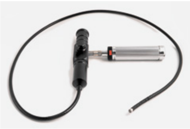
Abb. 3. Ein flexibles „Faserendoskop“ aus den 1990er Jahren mit integrierter Batteriebeleuchtung (in der Abbildung nach rechts ragendes, silbriges Bauteil). Arbeitsdurchmesser 6 mm, nutzbare Länge 1 m. Licht- und Bildleiter in Glasfasertechnik. Der Endoskopkopf kann mit Hilfe des schwarzen Kipphebels auf der Operatorseite per Bowdenzug ähnlich wie ein Finger gekrümmt werden, so dass in der Praxis die meisten erforderlichen Betrachtungsperspektiven erreicht werden können. Vorteil: klein, leicht, transportabel, funktioniert auch bei komplizierten Objektgeometrien. Nachteil: gering aufgelöstes, „pixeliges“ Bild, extrem kleines Gesichtsfeld
