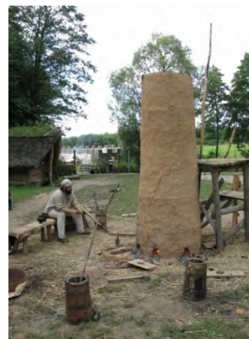
Ryc. 1. Piec doświadczalny w trakcie pracy („Dymarki Świętokrzyskie” 2014). Fot. P. Madera
