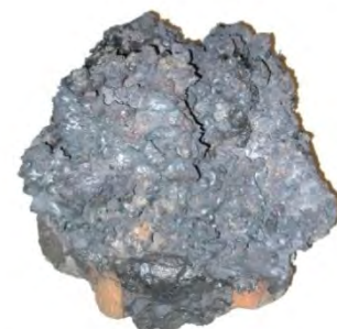
Ryc. 2. Fragment (pojedynczy „segment”) łupki żelaza – widok powierzchni górnej („Dymarki Świętokrzyskie” 2015). Fot. P. Madera
