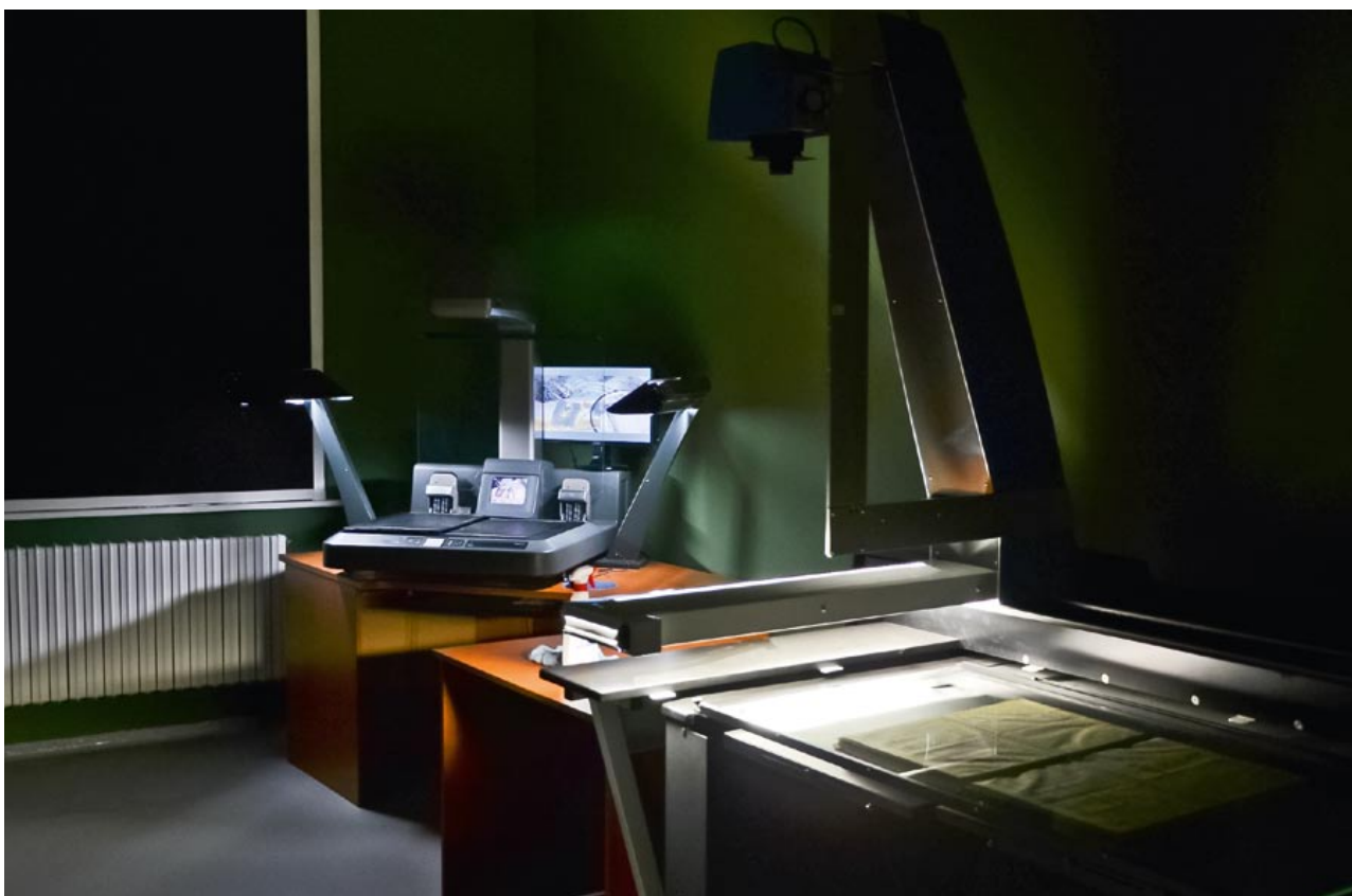
Ruční skenery pro digitalizaci knižních fondů a map na novém digitalizačním pracovišti
