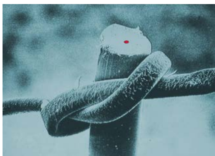
Mikroskop-Aufnahme: Männerhaar um eine Glasfaser, wobei nur der rote Punkt der eigentliche lichtleitende Anteil ist. Der Mantel „drumherum“ ist notwendig, um der Faser u. a. mehr mechanische Stabilität zu geben.
