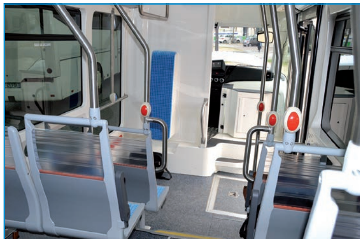
Le plancher de l'entrée avant est surbaissé pour accueillir notamment une personne en fauteuil roulant.
