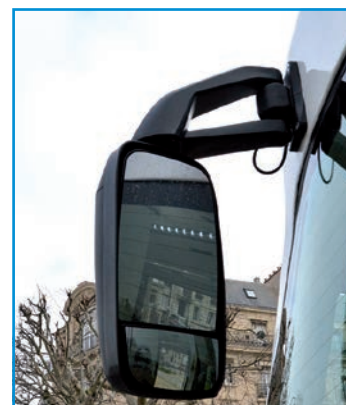
Les rétros sont largement dimensionnés pour permettre une vue bien dégagée vers l'arrière, ce qui n'est pas le cas de tous les minibus.
