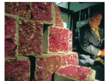
Prüfung der Carbonatisierung von Beton (Bilderberg, T. Ernsting)
