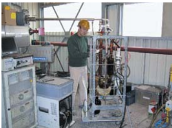
Emissionsmessungen für gasförmige anorganische Chloride sowie Dioxine und Furane
