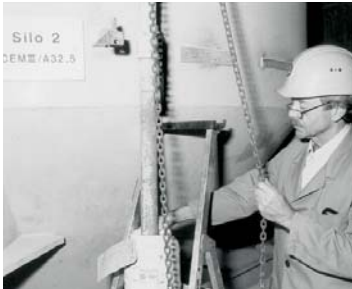
Mitarbeiter bei Zementprobenahme für Güteüberwachung
