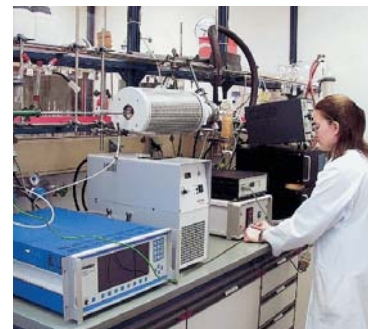
Simulationsanlage zur Messung von Emissionen aus Rohstoffen
