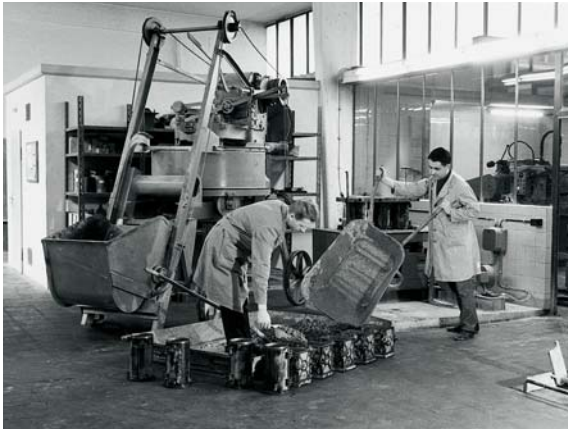
Herstellung von Prüfkörpern im Forschungsinstitut, 80er Jahre
