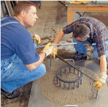
Blockiering-Prüfung an selbstverdichtendem Beton
