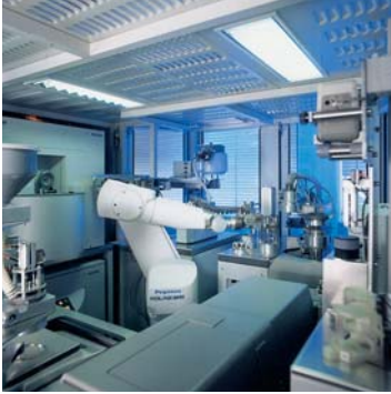
Beispiel einer robotergestützten Laborautomation der Qualitätsüberwachung in einem Zementwerk
