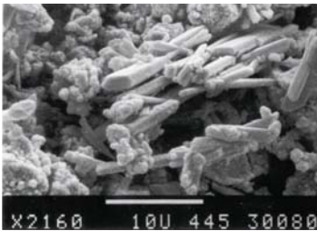
Rasterelektronenmikroskopische Aufnahme von Laborzement bei w/z = 0,40 nach 45-minütiger Hydratation bei 20\text{ °C} (Sekundärgipsgefüge)
