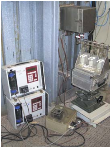
Messaufbau zur Probenahme von Fluorid und Chlorid
