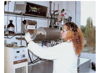
Gerät zur TOC-Bestimmung des organischen Kohlenstoffgehaltes in Kalkstein für Portlandkalkzementzemente
