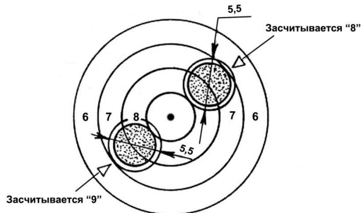
Рис. 1.13. Применение наружного калибра для определения достоинства пробоины в стрельбе из пневматической винтовки
