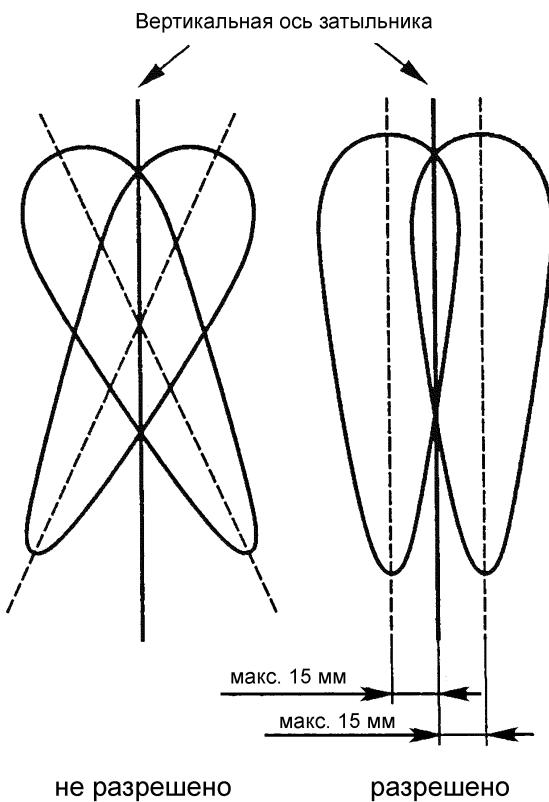
Рис. 2.5. Регулировка затыльника
