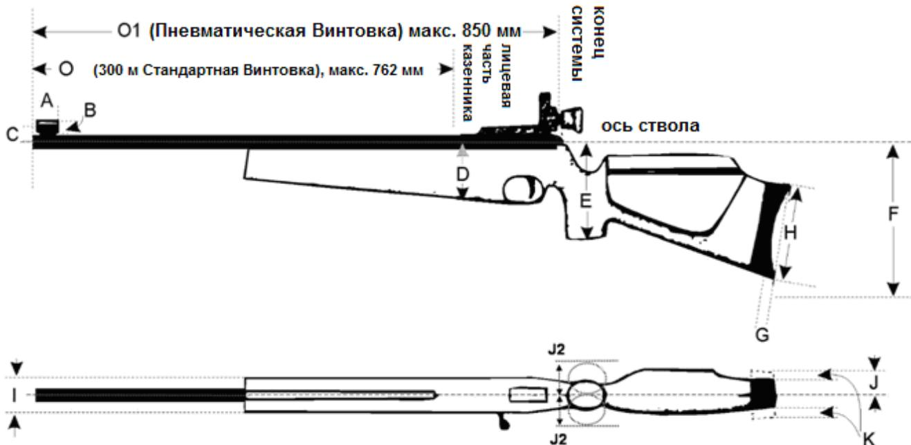
Рис. 2.4. Размеры стандартной крупнокалиберной и пневматической винтовки.
