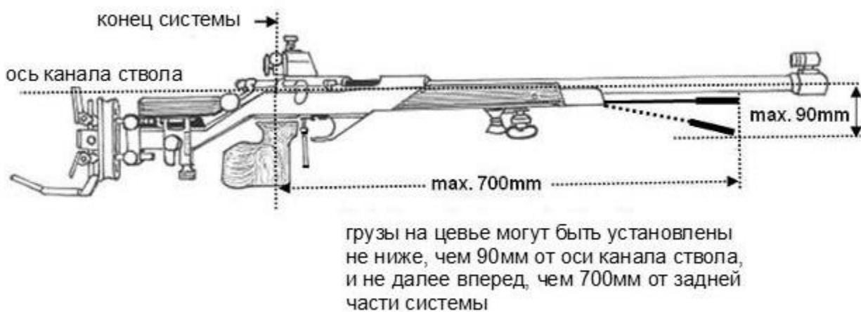
Рис. 2.3. Расположение грузов на цевье винтовки
