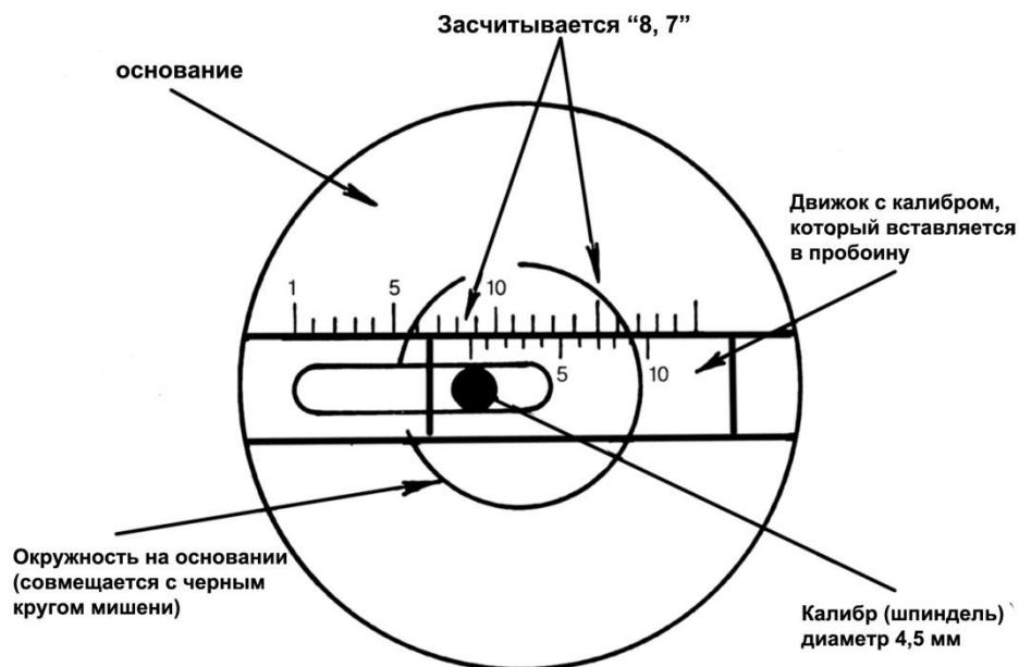
Рис. 1.19. Линейка с нониусной шкалой для определения достоинства пробоин с десятыми долями очка
