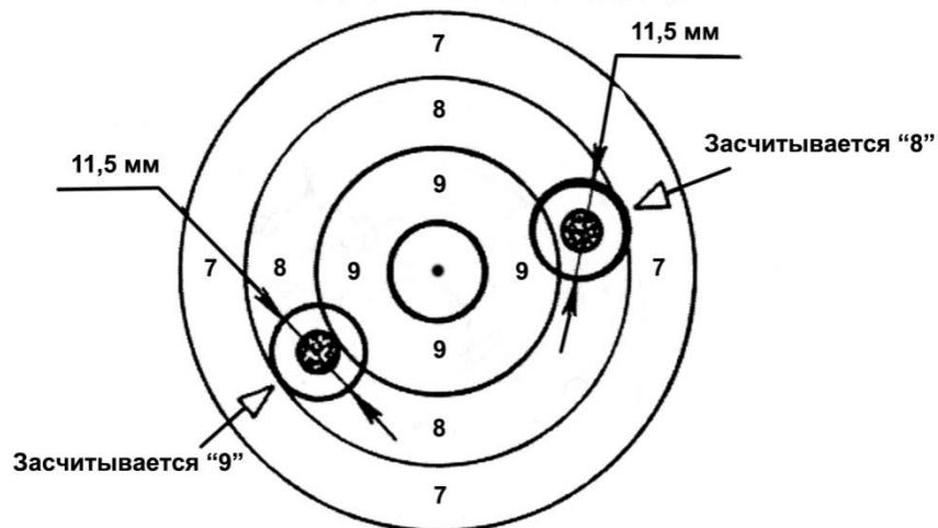
Рис. 1.15. Применение наружного калибра для определения достоинства пробоины в стрельбе из пневматического пистолета
