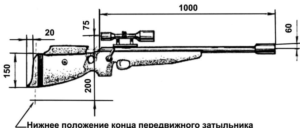
Рис. 4.1. Винтовка для стрельбы по движущимся мишеням
