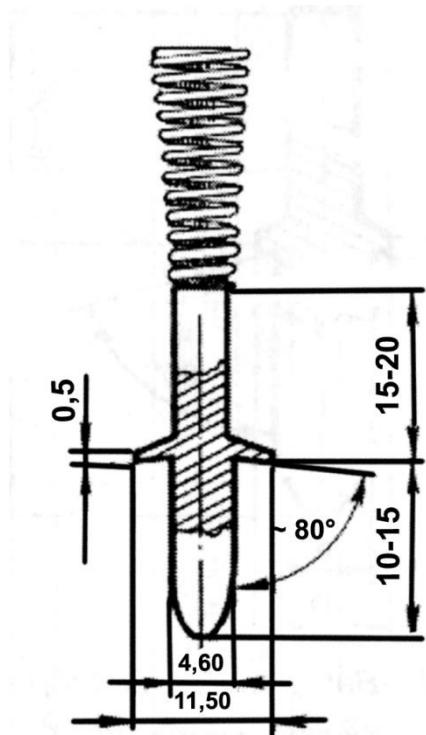
Рис. 1.14. Наружный калибр для определения достоинства пробоины в стрельбе из пневматического пистолета
