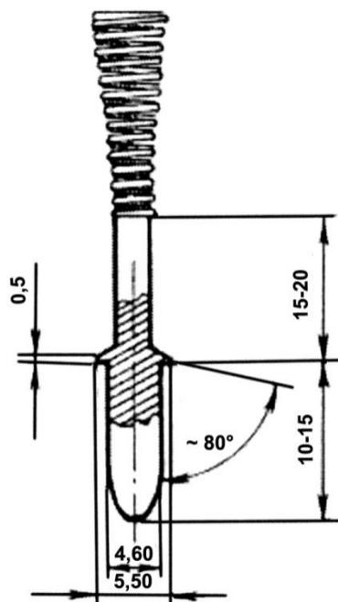
Рис. 1.12. Наружный калибр для определения достоинства пробоины в стрельбе из пневматической винтовки
