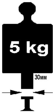
Рис. 2.7. Прибор для измерения толщины одежды
