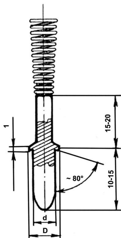
Рис. 1.16. Внутренний калибр для определения достоинства пробоины в стрельбе из малокалиберной и крупнокалиберной винтовки и пистолета (револьвера) центрального боя (таблица 1.4.)
