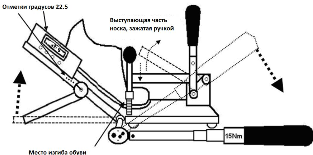
Рис. 3.4. Прибор для измерения эластичности подошвы.
