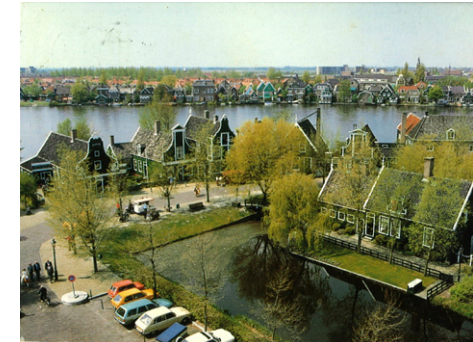
Profiel van de Kalverringdijk: de Zaan - achtertuinen - bebouwing - Kalverringdijk - sloot (brug) - bebouwing onderaan de dijk.
